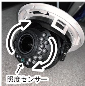
左図のように、照度センサーが下方向になるようにカメラユニットは回転しますので、設置する角度によって調整を行ってください。
